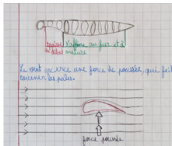
FIG. 32 Carnet d'un élève. La force de poussée crée une force rotative et provoque la rotation des pales.
