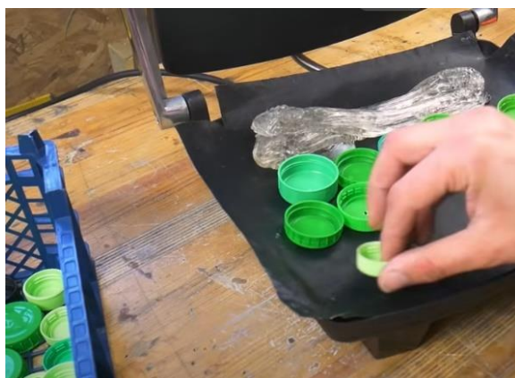
Figur 9: Plastikkapsler opvarmes og smeltes til genbrugsformål
