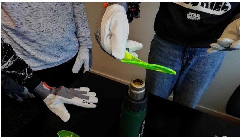
Figur 1: Elever bøjer en vindmøllevinge af akryl med en varmepistol.
