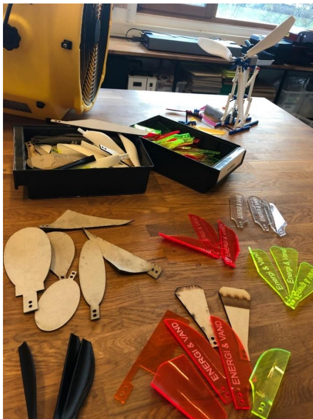
Figur 10: Forskellige designs af laserskårne vindmøllevinger
