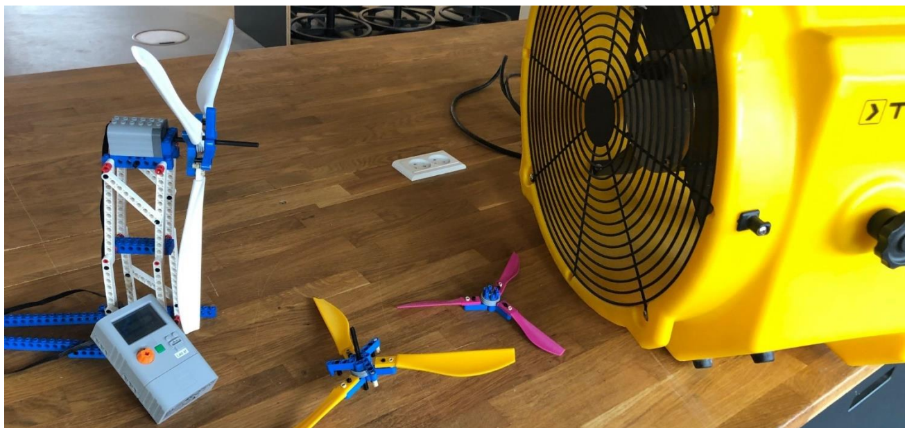
Figur 5: Eksempel på vindmølle, der er klar til test med vindmaskinen. Møllen er tilsluttet en energimåler.
