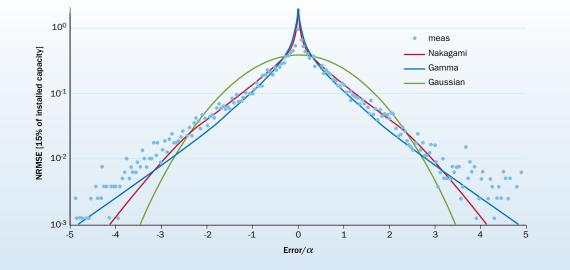
FIGURE 12: PROBABILITY DENSITY DISTRIBUTION OF ERRORS FOR DAY-AHEAD WIND POWER FORECAST FOR NORTH-WEST GER-MANY; ALSO SHOWN ARE FITTED GAUSSIAN, GAMMA AND NAKAGAMI DISTRIBUTIONS
